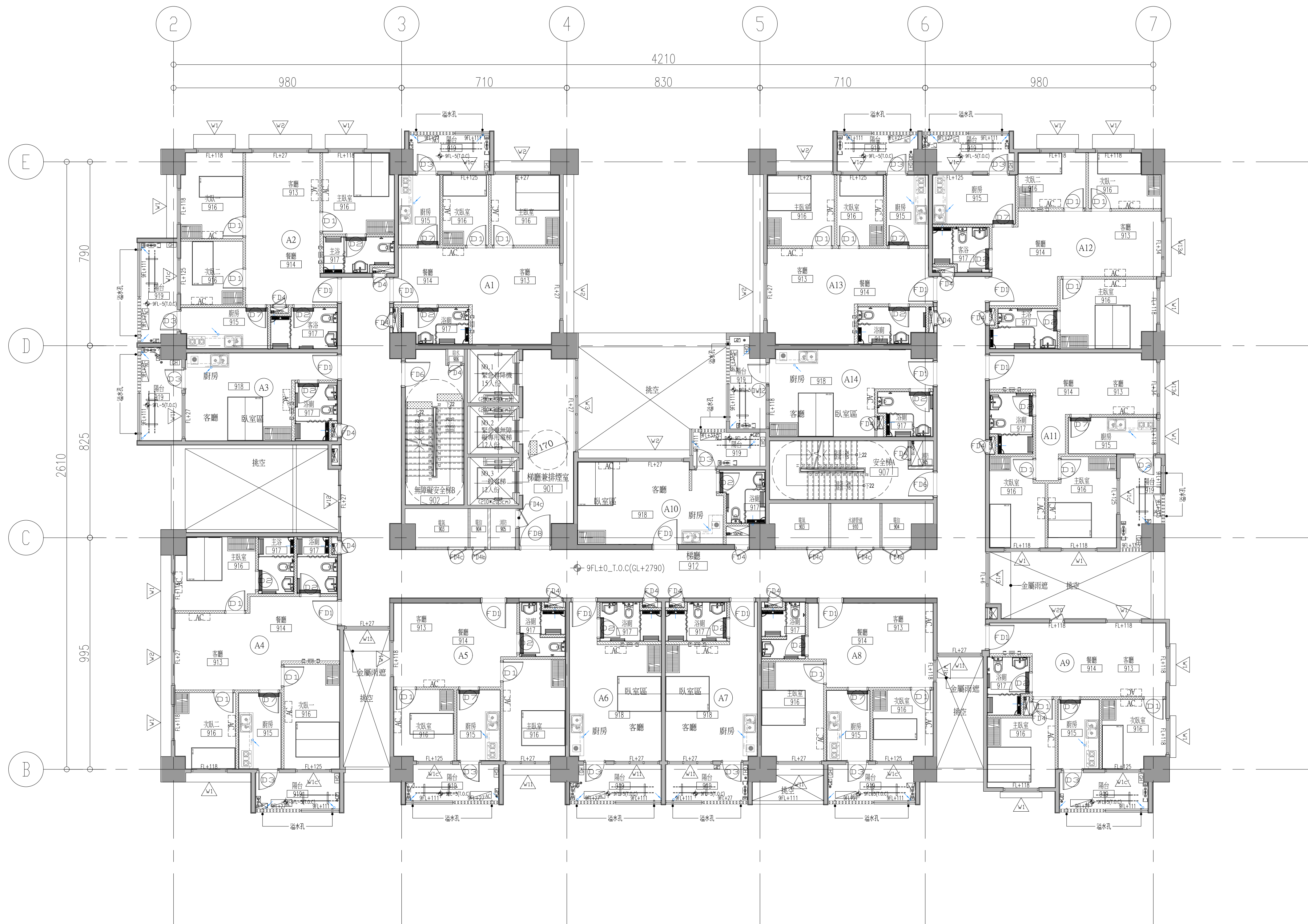
符號 說明 符號 說明 符號 說明 RC牆 Th:20cm 高程標示 自動體外心臟電擊去顫器 RC牆 Th:15cm 洩水方向 手動曬衣架 RC牆 Th:12cm 人孔蓋 洗衣槽 溼式輕隔間牆 Th:15cm (具一小時防火時效) 冷氣機 洗衣機 溼式輕隔間牆 Th:12cm (具一小時防火時效) 窗編號 熱水器 乾式輕隔間牆 Th:10cm (具一小時防火時效) 門編號 瓦斯錶 牆邊至牆邊 無障礙警示設施 瓦斯管 柱心至柱心 落水頭 壁掛式充電設備 牆心至牆心 防撞條 詳A9-04 截水溝 備註：陽台預留機電套房位置要加止水墩
