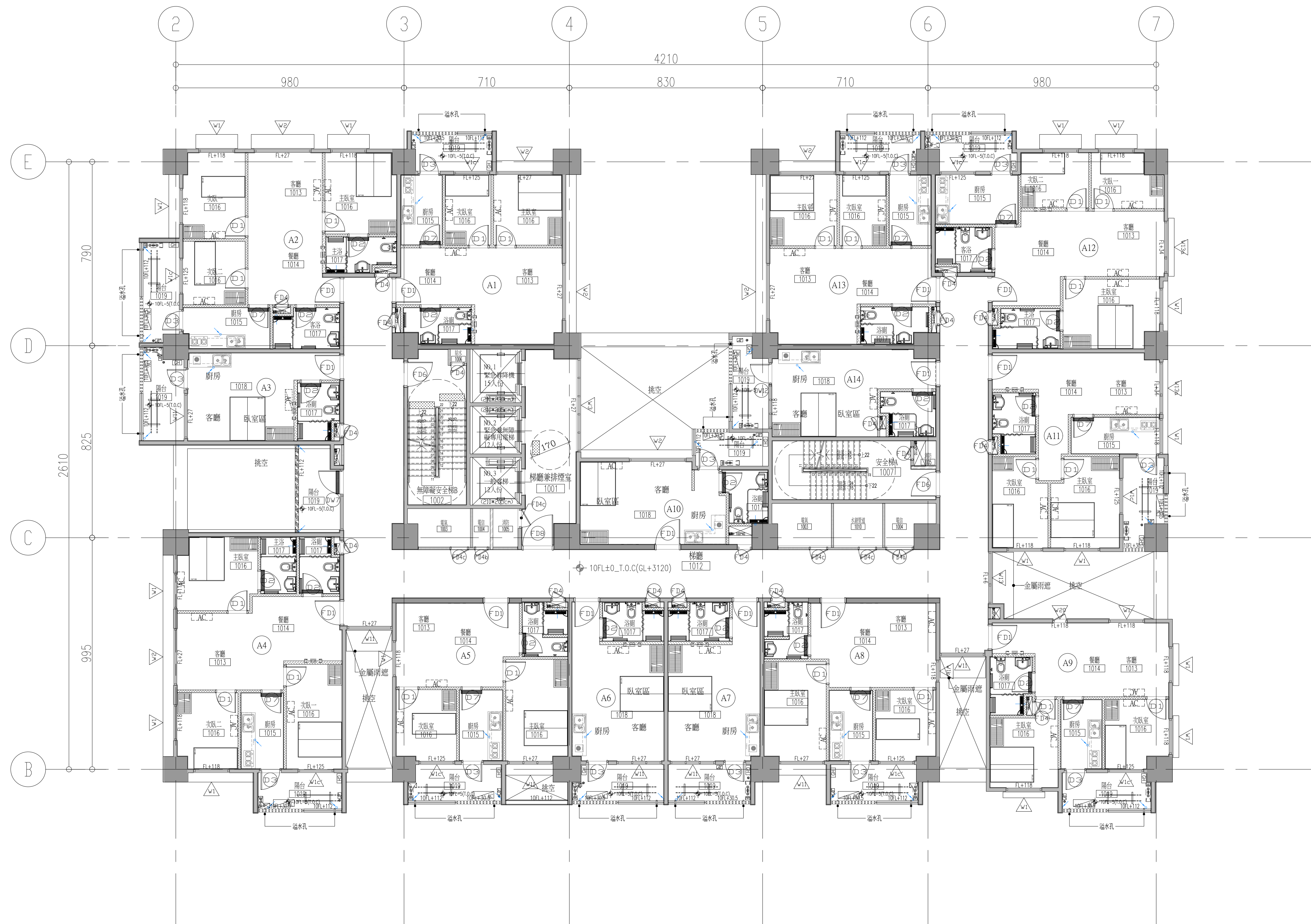
符號 說明 符號 說明 符號 說明 RC牆 Th:20cm 高程標示 自動體外心臟電擊去顫器 RC牆 Th:15cm 洩水方向 手動曬衣架 RC牆 Th:12cm 人孔蓋 洗衣槽 溼式輕隔間牆 Th:15cm (具一小時防火時效) 冷氣機 洗衣機 溼式輕隔間牆 Th:12cm (具一小時防火時效) 窗編號 熱水器 乾式輕隔間牆 Th:10cm (具一小時防火時效) 門編號 瓦斯錶 牆邊至牆邊 無障礙警示設施 瓦斯管 柱心至柱心 落水頭 壁掛式充電設備 牆心至牆心 防撞條 詳A9-04 截水溝 備註：陽台預留機電管位位置要加止水墩
