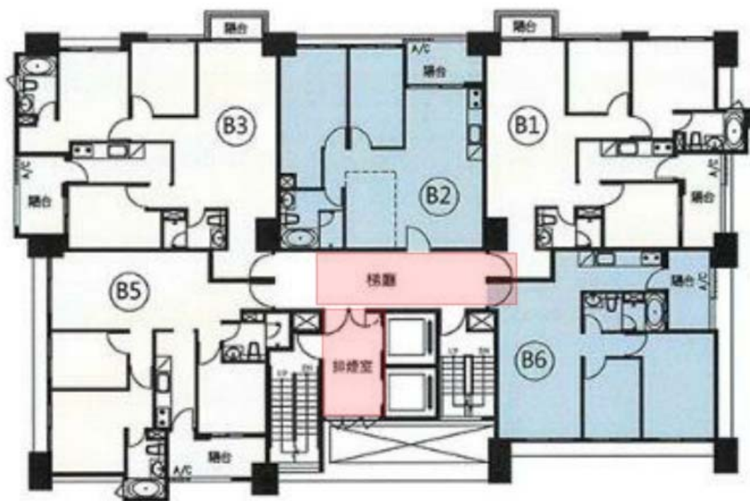
B 棟電梯出口處及梯廳，地面張貼保護材(紅色)示意圖
