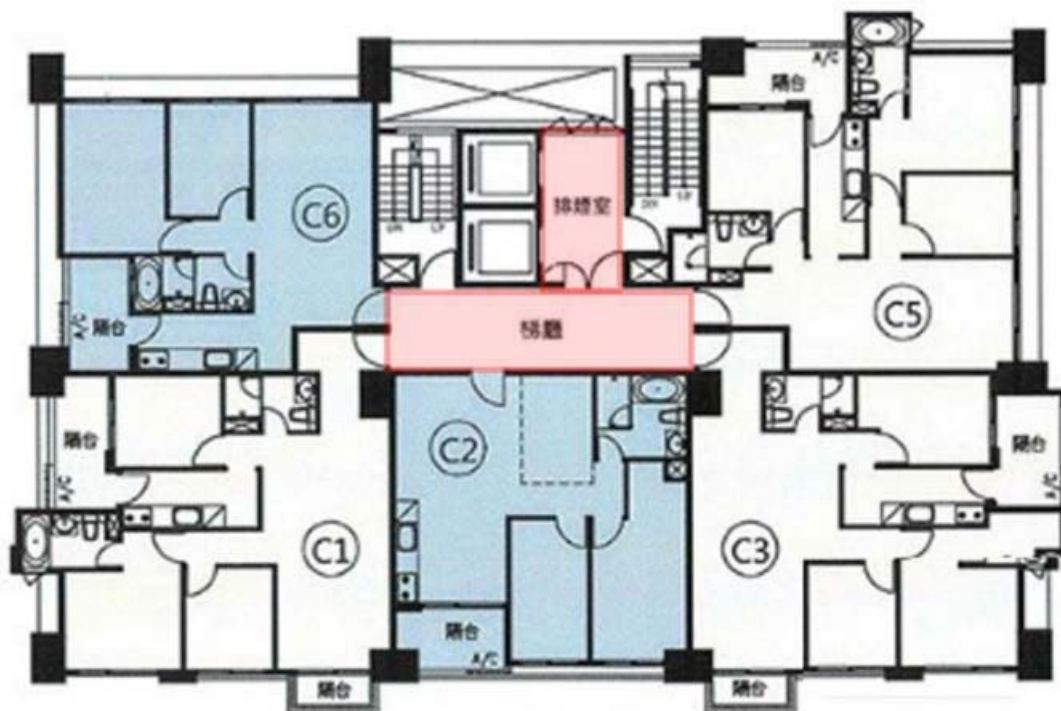
C 棟電梯出口處及梯廳，地面張貼保護材(紅色)示意圖
