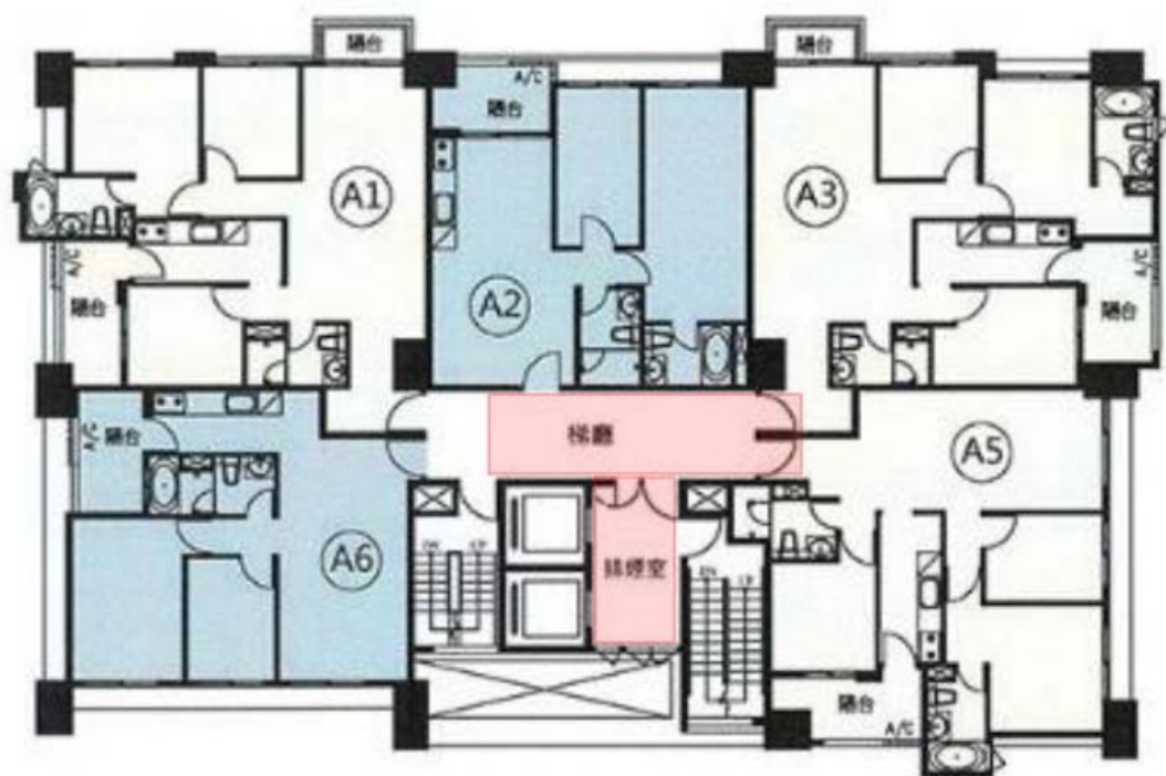
A 棟電梯出口處及梯廳，地面張貼保護材(紅色)示意圖
