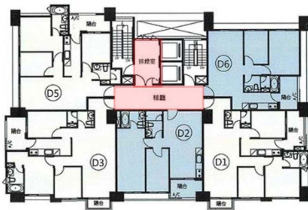
D 棟電梯出口處及梯廳，地面張貼保護材(紅色)示意圖
